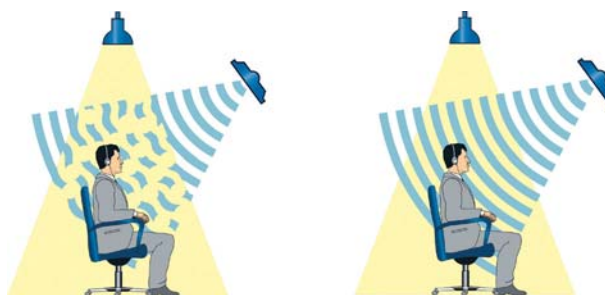
Ricezione distorta (a sinistra) con altri sistemi di distribuzione delle lingue e ricezione perfetta (a destra) con il sistema Integrus di Bosch
